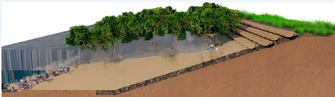
Figura 28. El revestimiento de roca (estructura dura) se construye en costas nuevas o ampliadas y tiene como objetivo reducir la energía de las olas y el paso de sedimentos. En la costa de baja energía detrás se pueden ubicar bosques de manglares de espesor modesto (característica basada en la naturaleza). Con la armadura acumulada en la pendiente hacia el mar, los manglares se pueden colocar en la elevación correcta entre el nivel del mar promedio y el máximo (Chim et al., 2022).
